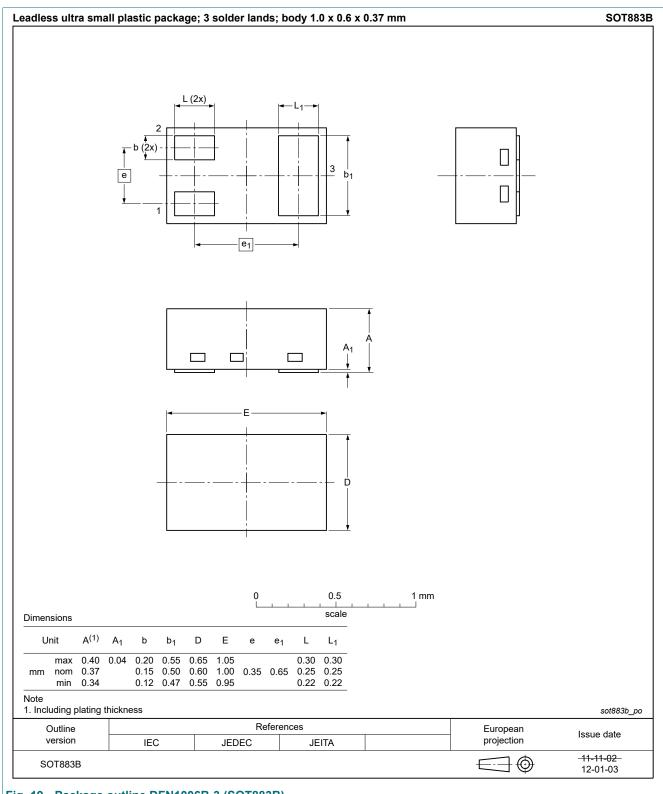
Fig. 19. Package outline DFN1006B-3 (SOT883B)
